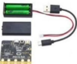
Micro:bit uređaj je edukativni mikroračunar koji ima 32-bitni procesor, senzore, ekran koji čine 25 LED dioda i konektori, pet ulaza i izlaza (I/O) koji se koriste za povezivanje mikro:bita sa drugim uređajima ili senzorima, Bluetooth podršku, mogućnost programiranja i napajanje sa dvije AA baterije.
